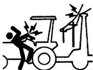
Tenha precaução quando circular debaixo de cabos elétricos de alta tensão.
